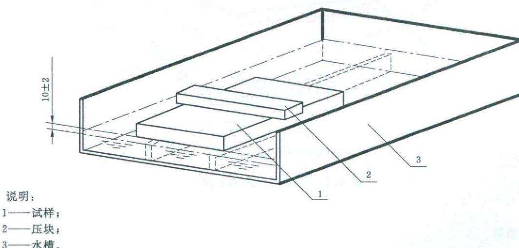
图 B. 1 试样浸水装置示意图
